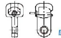
**ATTACCO A BOTTONE CON FORCELLA PER ISOLATORE DI ORMEGGIO IN VETRORESINA E TEFLON L.622**
