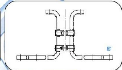
**MENSOLE PORTAISOLATORI PER CONDUTTURE TRIFASI DEL BLOCCO 10KV PER SOSPENSIONE SEMPLICE SU PALO Ø160 MM**
