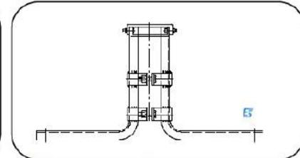
**MENSOLE PORTAISOLATORI PER CONDUTTURE TRIFASI DEL BLOCCO 10KV PER SOSPENSIONI DI SICUREZZA SU PALO Ø130 MM**
