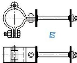
**COLLARE CON GAMBO COMPLETO DI BILANCIERE E GUARNIZIONI PER IL COLLEGAMENTO DI 2 ISOLATORI L.606 CON I TIRANTI DI POLIGONAZIONE CON ATTACCO A GANCIO**
