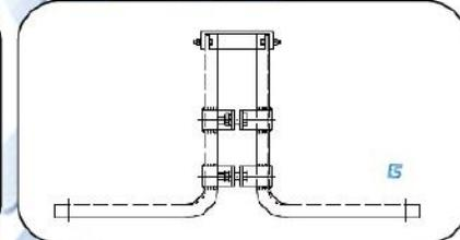
**MENSOLE PORTAISOLATORI PER CONDUTTURE TRIFASI DEL BLOCCO 10KV PER SOSPENSIONI DI SICUREZZA SU PALO Ø160 MM**
